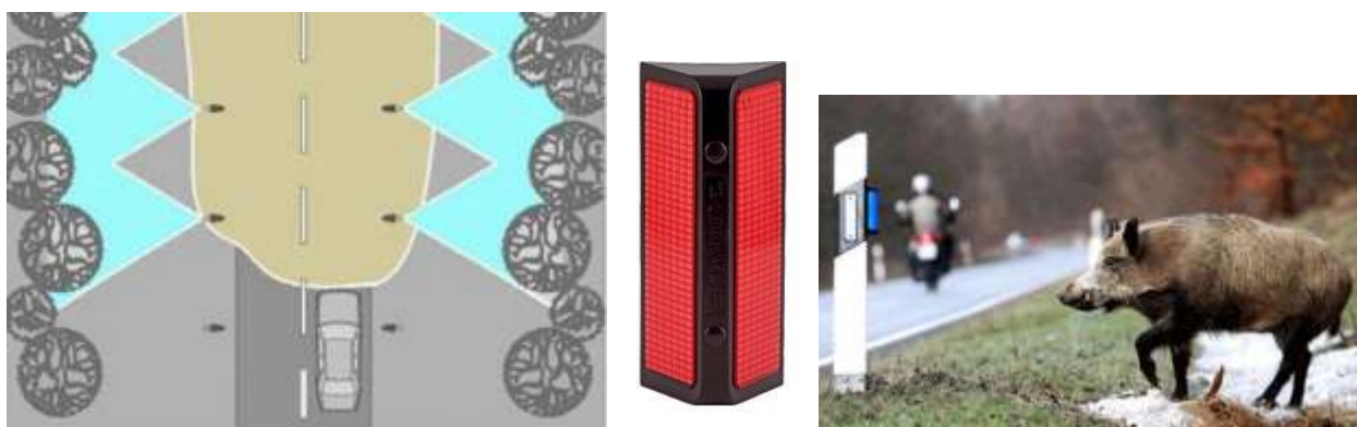
Figura 12: esempio di catarifrangenti per ridurre la probabilità di attraversamento della fauna selvatica
